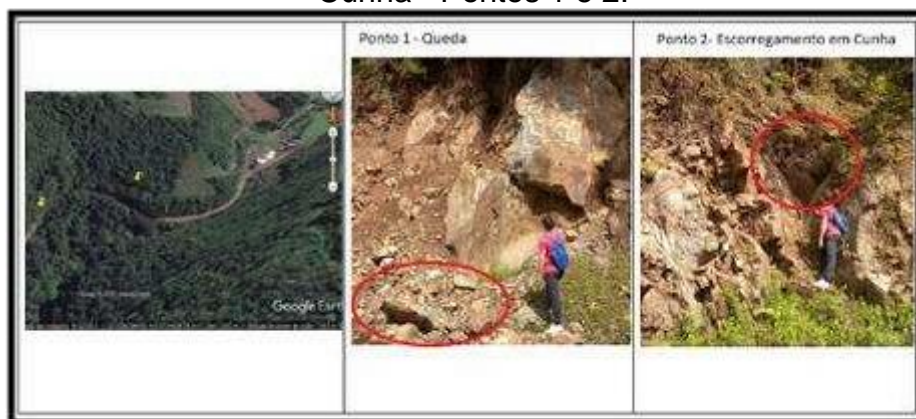
Figura 3: Mosaico: Movimentos de Massa - tipo: Queda e Escorregamento em Cunha - Pontos 1 e 2.
