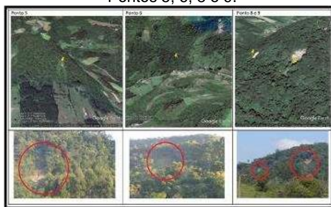
Figura 5: Mosaico: Movimento de Massa - tipo: Escorregamento Planar - Pontos 5, 6, 8 e 9.
